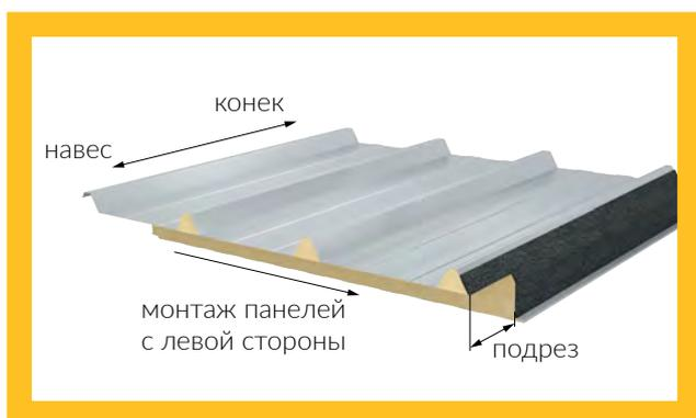
левый подрез кровельной панели
