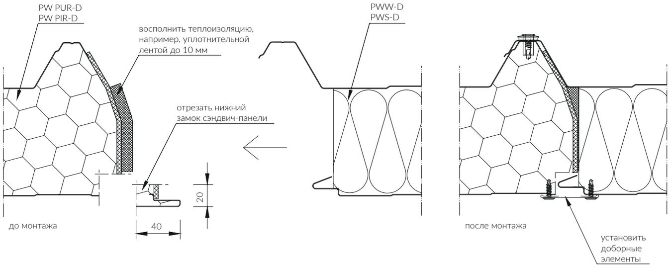
СОЕДИНЕНИЕ ВНЕШНЕ СОВМЕСТИМЫХ СТЕНОВЫХ СЭНДВИЧ-ПАНЕЛЕЙ PW PUR/PIR-D С PWW-D / PWS-D
